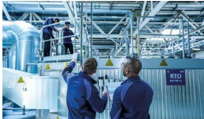
O BMW Group está implementando um novo método de purificação de exaustão em suas áreas de pintura, utilizando eletricidade em vez de gás natural. Na prática, esse método permite que as altas temperaturas necessárias para a purificação térmica dos gases de exaustão sejam geradas por eletricidade, eliminando a dependência de combustíveis fósseis.
