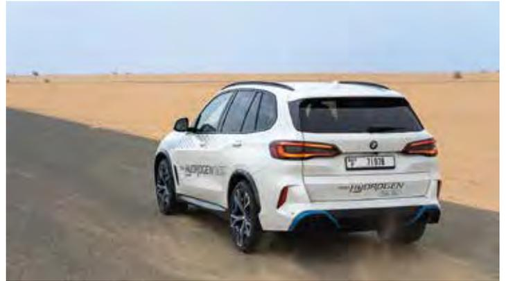
Lançar uma nova tecnologia exige uma série de testes em todas as condições possíveis, até mesmo as mais extremas. Depois de passar por testes no frio intenso de Arjeplog, o BMW iX5 movido a hidrogênio experimentou um pouco de calor no deserto dos Emirados Árabes Unidos. Por lá, o sistema de propulsão a hidrogênio passou por testes em temperaturas de até 45°C, além de enfrentar areia e poeira.
